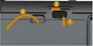
(d) Remove the I/O door and back enclosure
