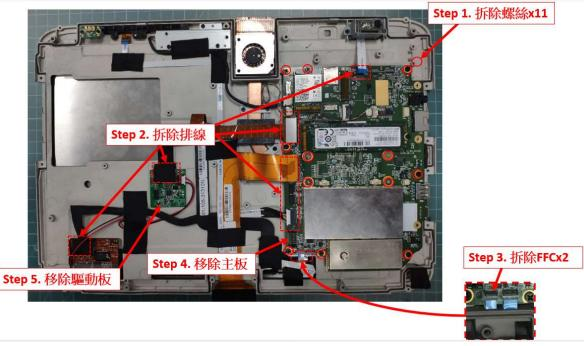
(f) Remove DC fan and thermal module
